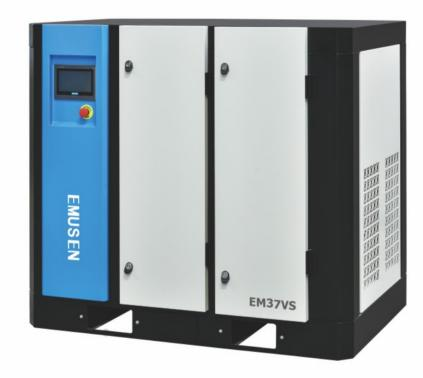
高效永磁(IPM)电机,结构紧凑,优化的冷却设计,效果显著,电机无轴承,无油脂,延长了有效工作时间 直接传动、卧式设计,更少零部件、无齿轮和皮带,连轴器装置、紧凑,减少占地面积 变频器、电控柜强制冷却,无需额外冷却风扇、全封闭、无杂质进入、外置散热片,单独冷却
